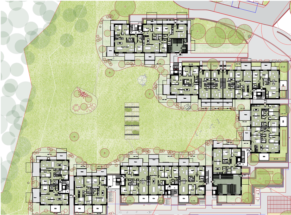
Grundriss Erdgeschoss, erste Etappe Nordwest: Die Geschosswohnungen sind fast alle zweiseitig orientiert – sowohl zu den Erschliessungsgassen als auch zum Grünraum hin. / Plan du rez-de-chaussée, première étape nord-ouest: les appartements présentent quasiment tous une double exposition, vers les ruelles de desserte comme vers les espaces verts.
